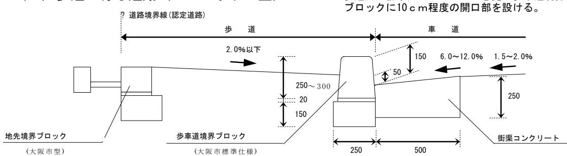
※歩道内の排水処理のため10m感覚で歩車道境界ブロックに10cm程度の開口部を設ける。
